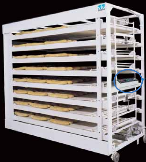
Chargeur automatique multi-niveau
